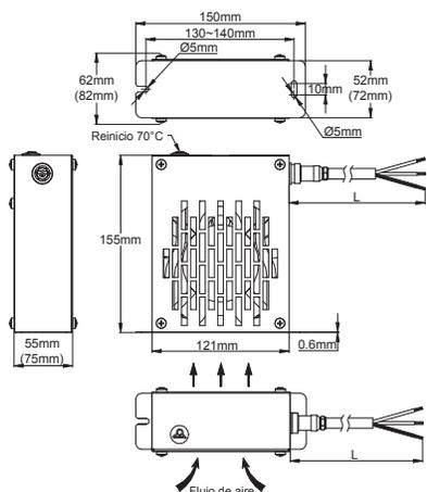
**Modelo 9PF1:** Para control remoto mediante termostato o higrostat, tiene solo un limitador de temperatura de reinicio manual con configuración fija.
