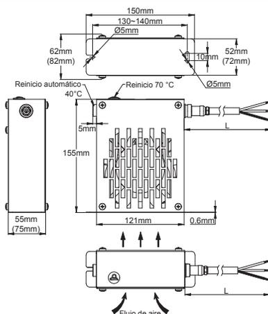
**Modelo 9PF2:** Autocontrolado, equipado con un termostato de control de configuración fija y un limitador de temperatura de reinicio manual con configuración fija.
